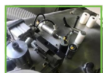
Узел предварительной обрезки кромки из рулона (гильотина)
