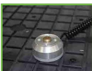
Датчик измерения и калибровки длины инструмента
