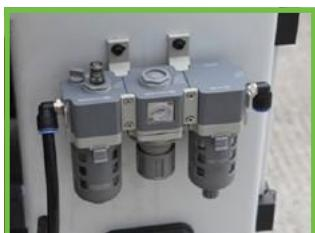
Блок подготовки воздуха, с помощью которого регулируется общее давление в пневмосистеме, а также первичная фильтрация подаваемого в станок воздуха.
