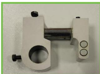
**УСТРОЙСТВО ДЛЯ ЗАТОЧКИ ПОДРЕЗНЫХ ДИСКОВЫХ ПИЛ ДИАМЕТРОМ ОТ 100 ММ**
