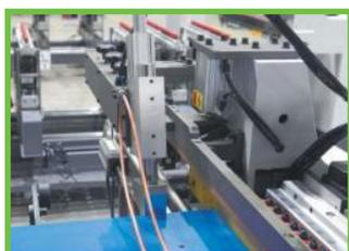
Перемещение вертикальных сверлильных групп происходит по линейным направляющим, что обеспечивает точность работы.
