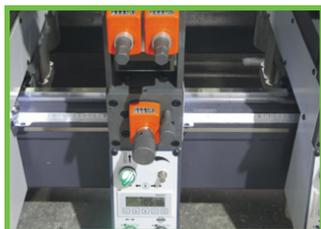
Позиционирование вертикальных сверлильных групп происходит с точностью до 0,1 мм, благодаря микрометрическим упорам и электронным цифровым датчикам, которые так же сокращают время установки размеров при настройке по ширине и обеспечивают высокую точность
