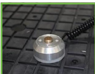
Датчик измерения и калибровки длины инструмента
