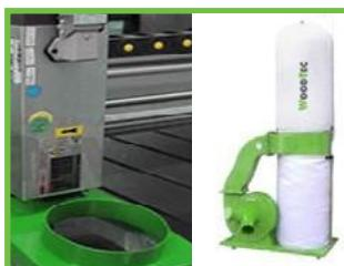
Аспирационный кожух и пылеулавливающий агрегат
