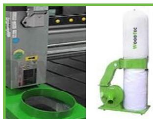
Аспирационный кожух и пылеулавливающий агрегат
