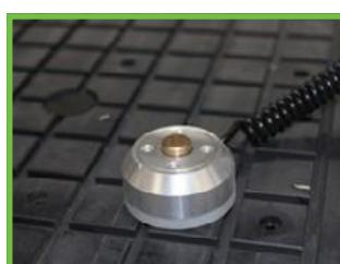
Датчик измерения и калибровки длины инструмента
