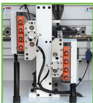
Предназначен для удаления микроволны на обработанной радиусной поверхности кромки после узлов фрезерования.
