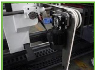
Устройство автоматической подачи заготовки
