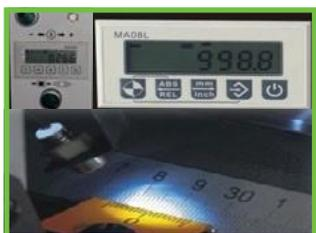
Позиционирование вертикальных сверлильных групп происходит с точностью до 0,1 мм, благодаря микрометрическим упорам и электронным цифровым датчикам, которые так же сокращают время установки размеров при настройке по ширине и обеспечивают высокую точность.
